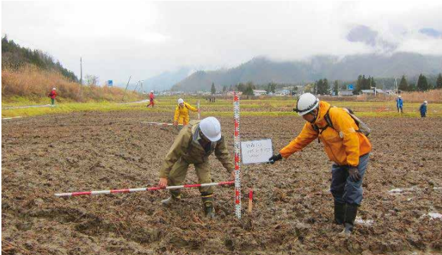
水田に生じたうねり。これは撓曲(とうきょく)といって、地下で断層がずれたとき、軟弱な表土がたわむように曲がる現象(飯森区)
