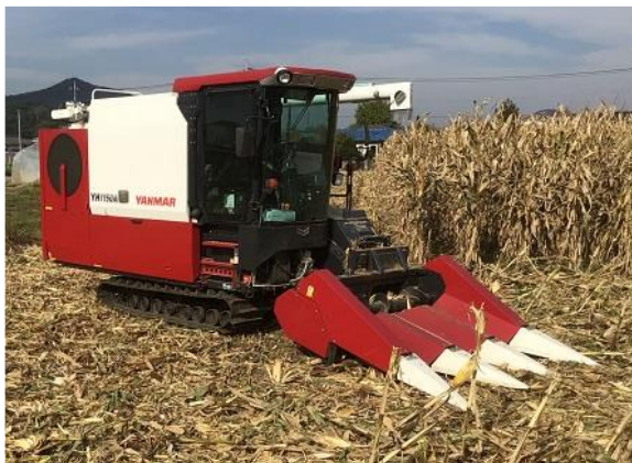
写真14 普通型収穫機とコーンヘッド (撮影:令和4年11月10日)
