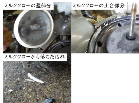
図6 ミルクローのゴムパッキンの汚れ
