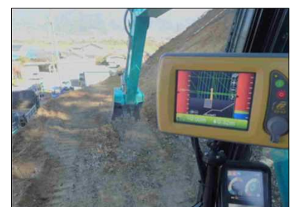
ICT建設機械による自動施工、作業の省力化（測量・丁張・誘導員などが不要）
