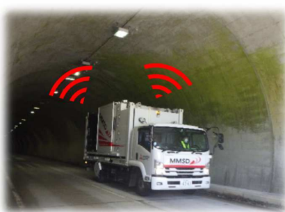
走行画像計測車 (交通規制を伴わず画像撮影、レーザ測量が可能)
