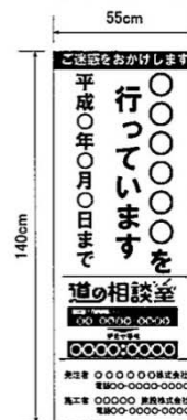
(様式4) 工事説明看板 (占用企業工事)
