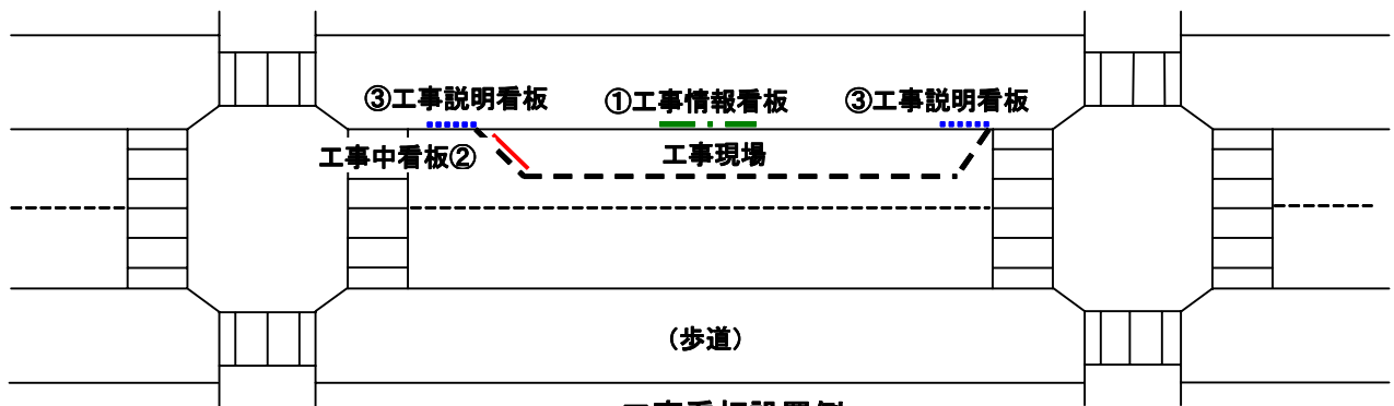
工事看板設置例
