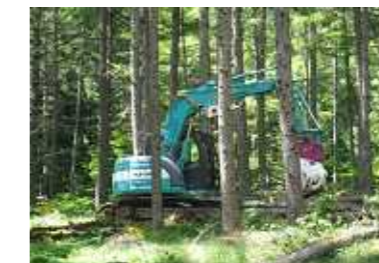
材を利用するための 「搬出間伐」を実施中
