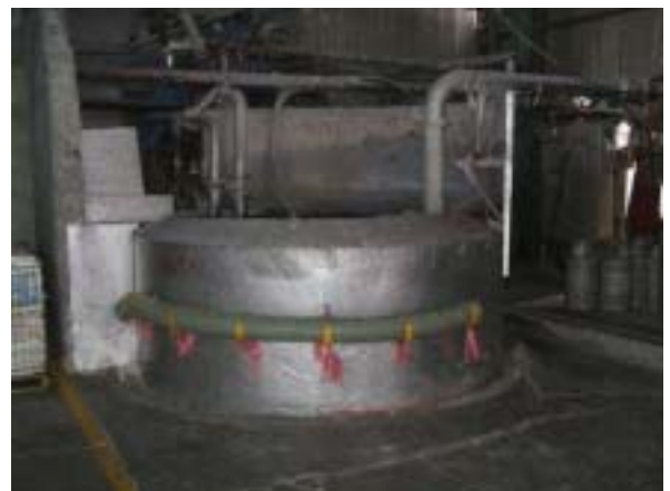
製紙工場に設置されたパルパー 写真提供：三菱製紙株式会社（静岡県富士市）
