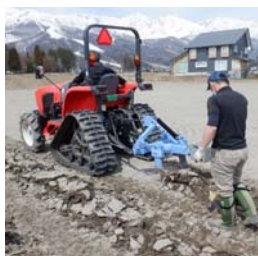
カットブレードによる排水対策
