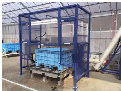
投入破砕機 約118kg/回(30回/日)
