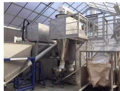
乾燥機 乾燥能力: 約400kg/h
