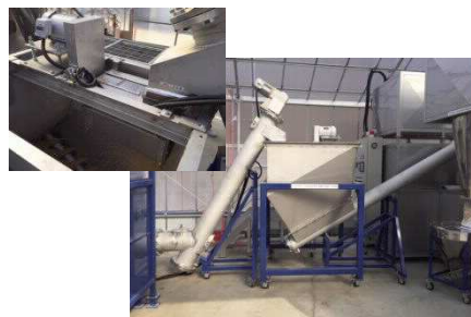
粉碎貯留ホッパー 貯留量: 約300kg
