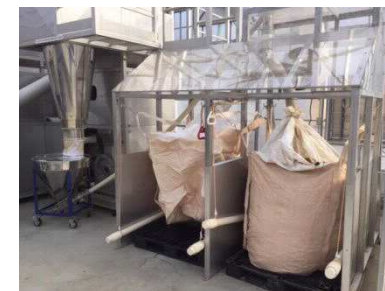
フレコン投入機 処理能力: 約1000kg/h
