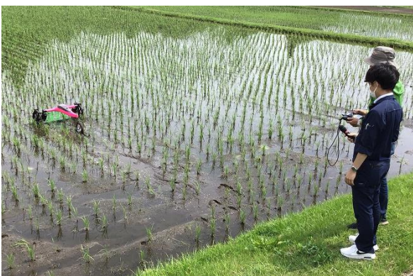
写真1 リモコン式除草機「ミズニゴール」の実演
