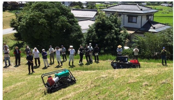
写真2 傾斜地でのリモコン式草刈機の実演
