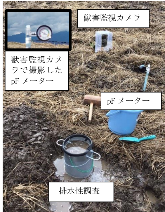
写真2 耕盤破碎前排水性調査、pFメーター継続記録調査
