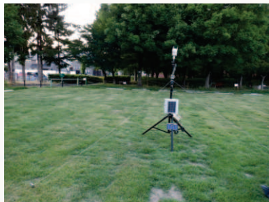
長野市若里公園の芝地舗装の駐車場に設置した気象観測機器
