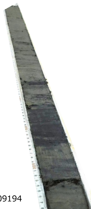
掘削された堆積物コア （掘削長：30.0 m, 最深部の年代：約2.6万年前）
