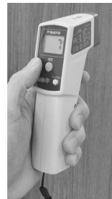
図1 本プログラムで用いた赤外線放射温度計（SK-8700 II：株式会社佐藤計量器製作所製）
