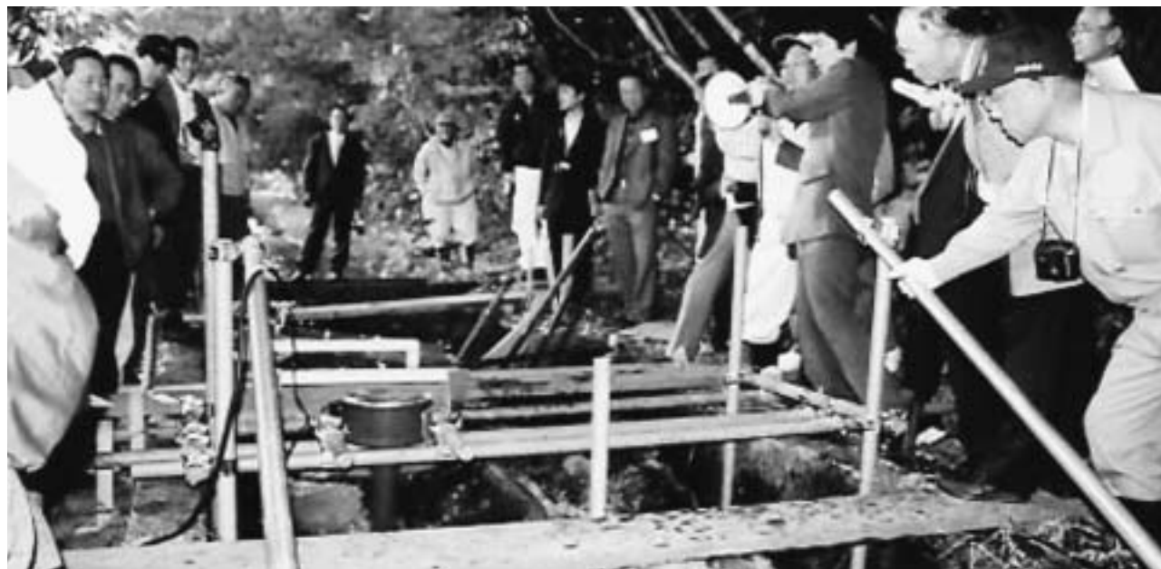
農業用水路を使ったミニ水力発電の公開実験(国土交通省の水利用許可取得済)
