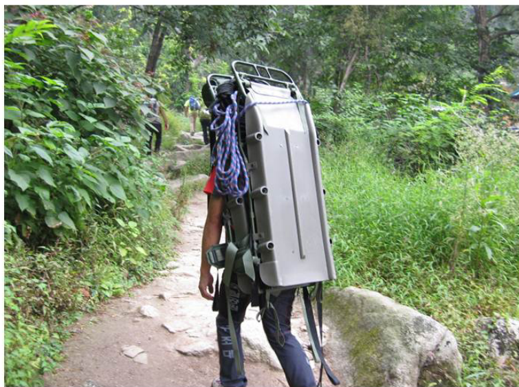
2分割の救助用担架 岩場と雪上兼用である。重量は約5キロで軽量である。
