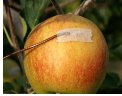
図 9 果実の表面温度変化をセンサーで測定し、日焼け発生程度に及ぼす影響を調査
