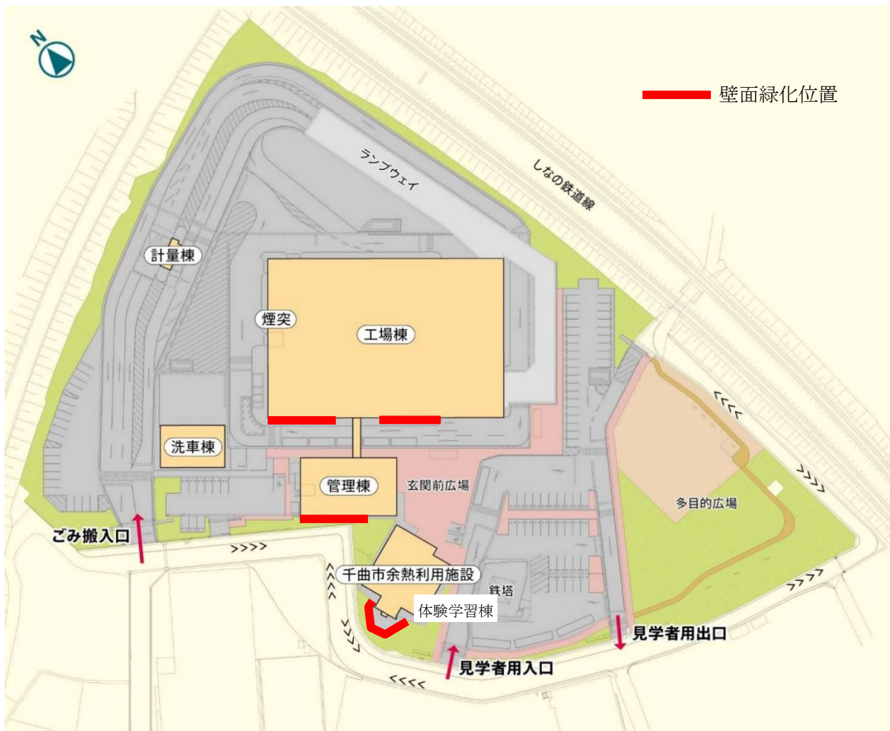
図 2-1-2 壁面緑化の施工位置
