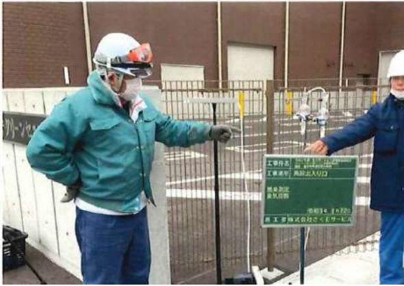
写真 3. 2. 14 悪臭の調査実施の様子
