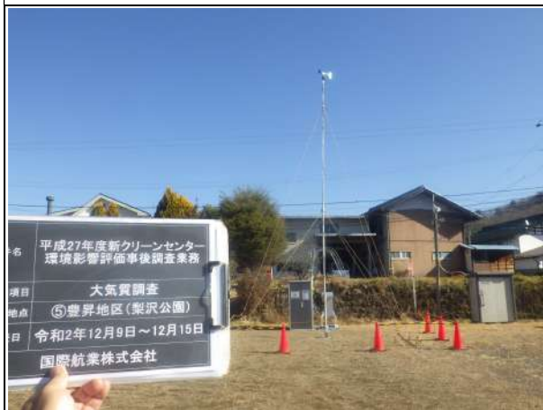
写真 3.2.3 機材設置状況 （一般環境大気質：地上気象）
