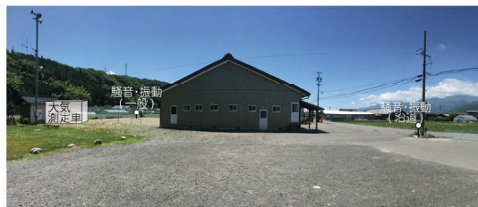
※大気測定車を設置。 沿道で騒音・振動(沿道)を測定。 騒音・振動(一般)は沿道影響を考慮し 建物背後で測定。
