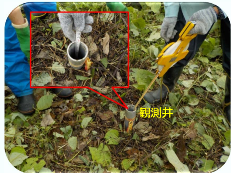
地下水位調査 ▲
