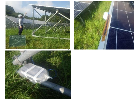
熱電対ロガーによる表面温度 (太陽光パネル設置場所内)
