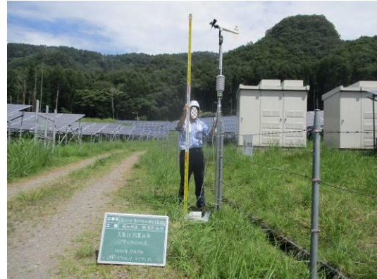
気温・湿度・風向・風速 (太陽光パネル設置場所の中央付近)
