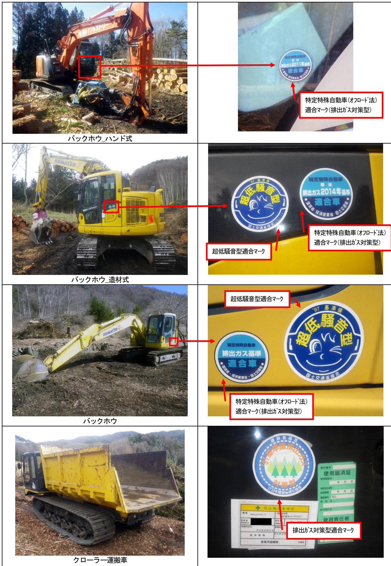
写真4-5：排出ガス対策型・超低騒音型建設機械の使用状況写真
