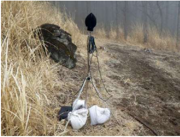
写真6.3-8 希少猛禽類コンディショニングに係る騒音計設置状況（令和5年3月17日）
