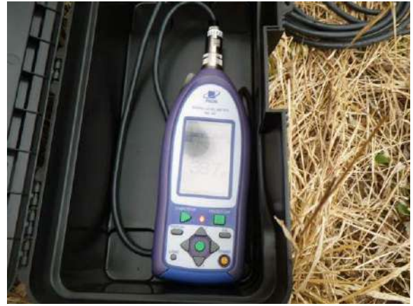
写真6.3-8 希少猛禽類コンディショニングに係る騒音計設置状況（令和5年3月17日）
