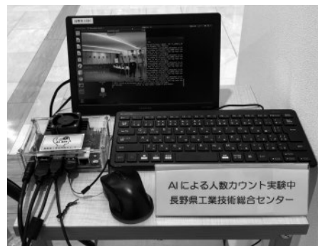
AI技術導入支援に利用する「センターAIキット」 （AI活用/IoTデバイス事業化・開発センター独自開発）
