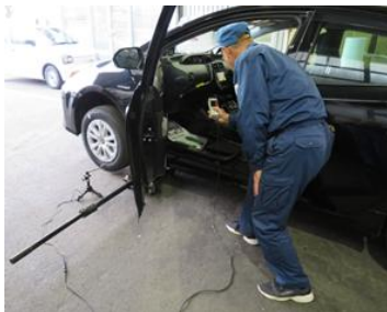
タクシーメーター検定（装置検査）
