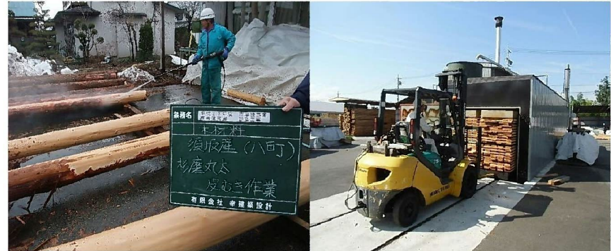
杉磨き丸太皮剥作業・ラミナ材の乾燥
