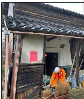
【建物の傾斜の大きさ調査】 「下げ振り」という道具を使って建物の傾斜を調べます
