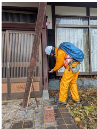
【建物の傾斜の大きさ調査】 「下げ振り」という道具を使って建物の傾斜を調べます
