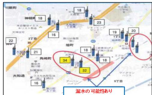
漏水の可能性箇所の絞込みが可能
