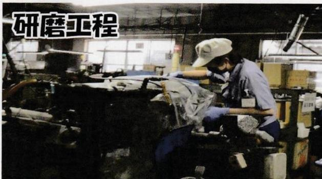
研磨機（センタレスグラインダー）を使用して、表面をきれいに仕上げます。
