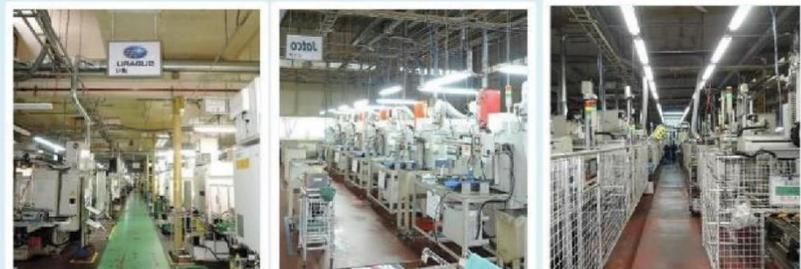
機械加工は、自動化・省力化されたラインを中心に1個ずつ加工していきます。自社製のロボットシステムを最大限に活用した省力化を実現しています!
