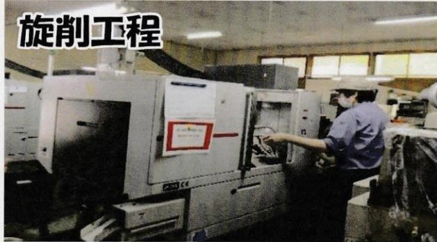
コンピューター制御の旋盤で、長い棒材を指定された形状に加工します。
