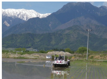
スマート農業田植機(地力データに基づき施肥量を自動制御)(池田町)
