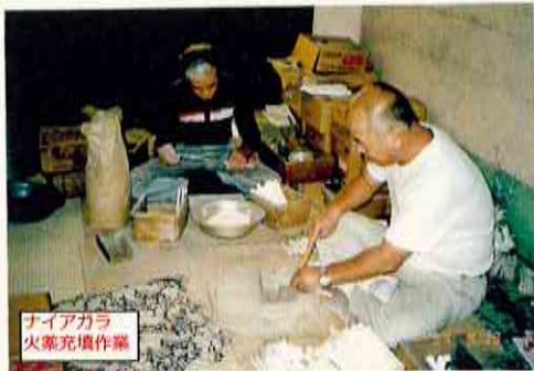
立火 火薬充填作業
