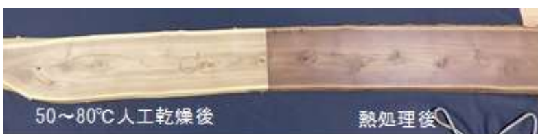
写真2 乾燥後と熱処理後の対比
