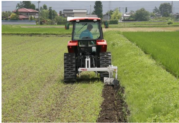
【額縁明渠の設置】
