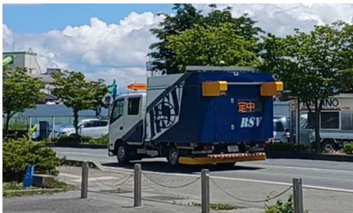
※LiDAR: レーザー光の物体表面からの反射を捉えることで距離測定を行う技術 ※レーダー: 電磁波の透過性の高さを利用して、地中内部までの距離測定を行う技術
