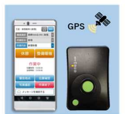
GPS端末を除雪車両に設置
