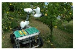
中山間地に適応可能な 果樹用自動収穫ロボットの開発 (株)イーエムアイ・ラボ(富士見町) 「センターが保有するロボットやAI学習 用並列処理コンピュータ等を利用させてい ただきながら研究を進めてきました。」
