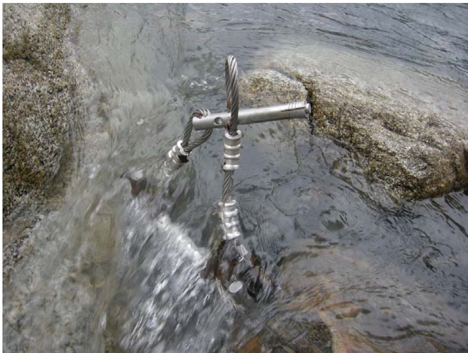
抜けた太いアンカーの様子
