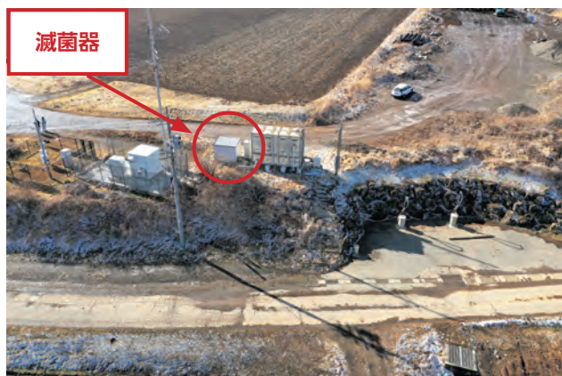
葉物野菜の品質向上のため、防除用水等として利用する沢水の減菌器を整備
