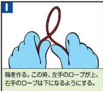
1 輪を作る。この時、左手のロープが上、右手のロープは下になるようにする。
