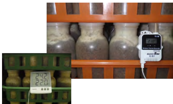
【〇】 温度計・温度ロガーの設置
