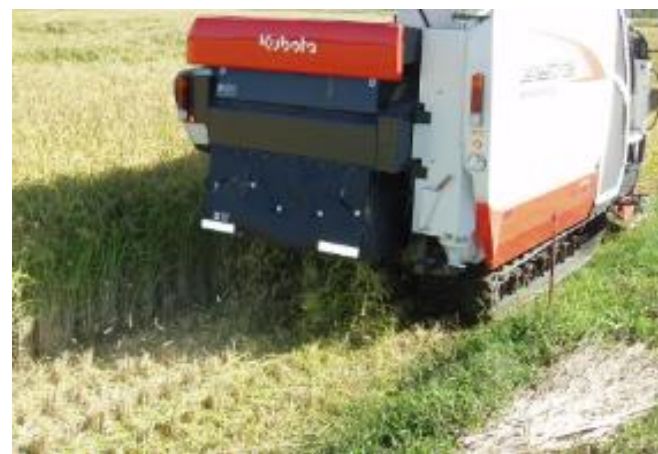
水稻立毛間播種では、コンバインから排出される稲わらを覆土代わり
