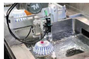
人手不足に対応する食洗機ロボット 資料：コネクテッドロボティクス株式会社
