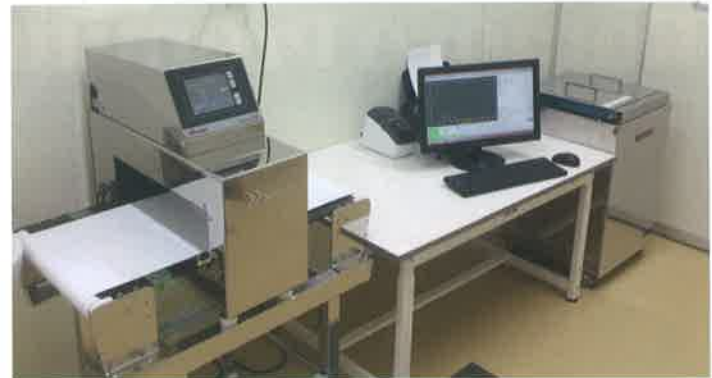
小諸市野生鳥獣商品化施設(検査室) 写真左:金属検出機 写真右:放射能検出機
