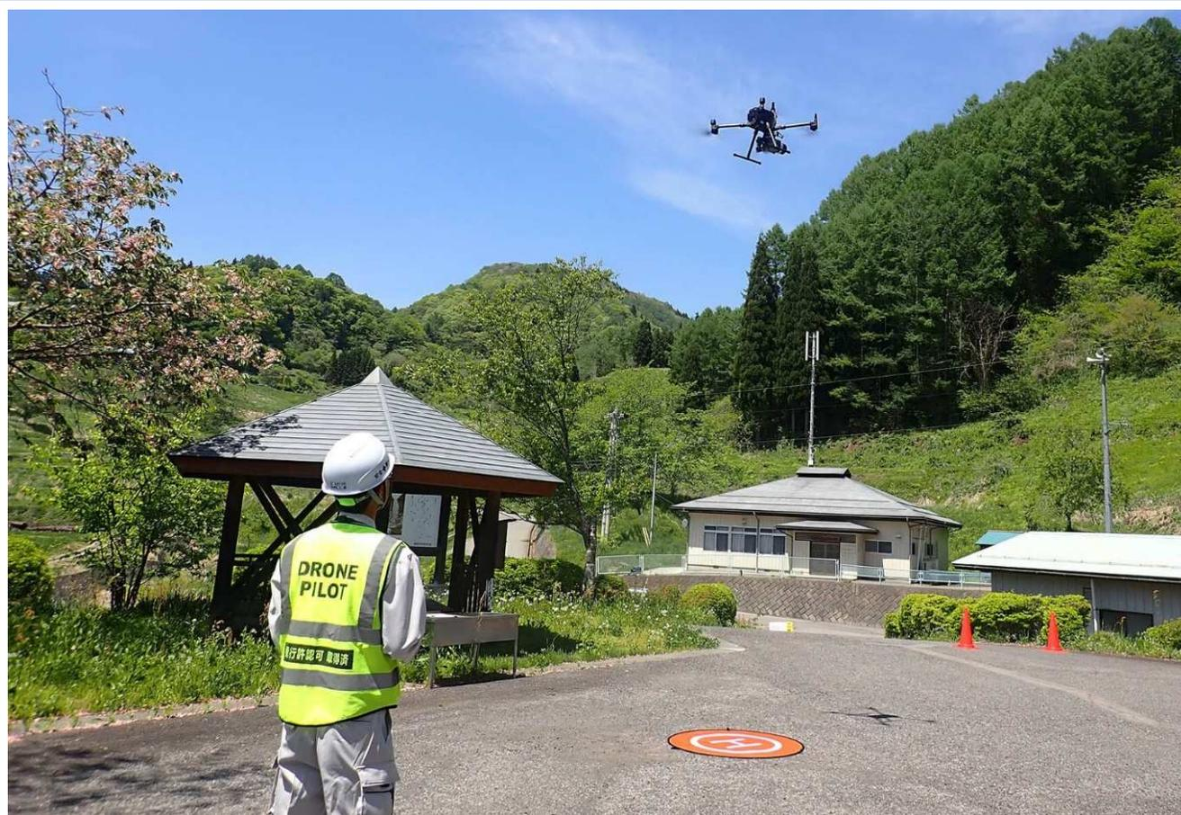
ドローンに搭載したレーザ測量機により、上空からレーザを照射して地上を測量します。
