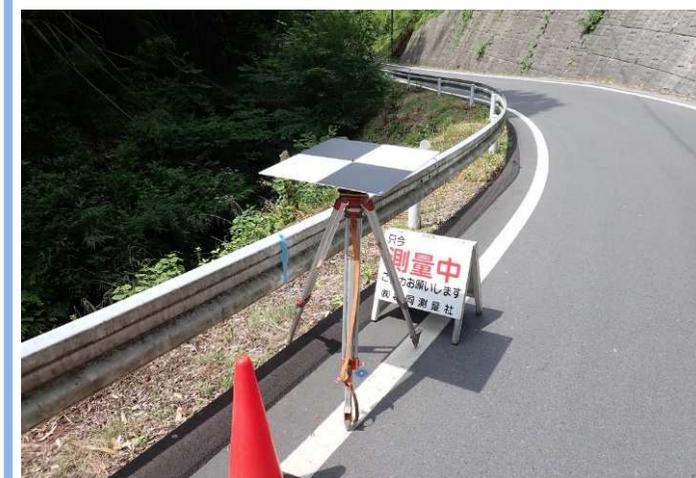
ドローンによる測量では測量精度を確保するため、作業中は「調整点」や「検証点」と呼ばれる目標物を地上に設置し、公共測量の求める精度を満たしているか確認します。
