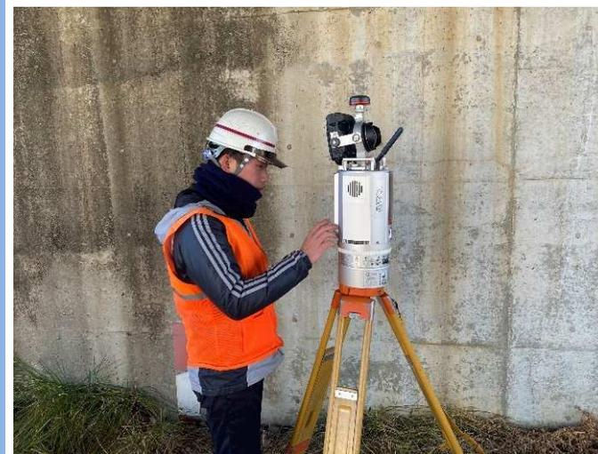
ドローンによる測量がメインですが、基準点測量や補足測量については、地上での作業も行います。
