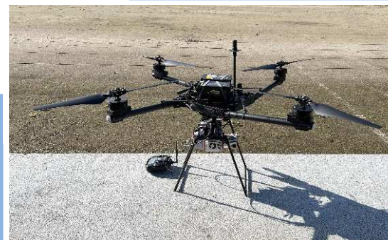
測量用ドローン（レーザ測量機を搭載）
