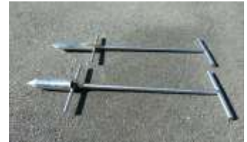
コンテナ苗木植栽用にスピード（奥）とディブル（手前）といった手工具も開発
