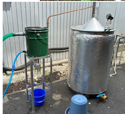
当所で開発、普及を進める ドラム缶式精油採取装置
