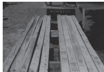
図1 乾燥温度別による試験材一本当たりの割れ長さ（1980） 写真1 割れの様子（左：55℃乾燥、右：100℃乾燥）
